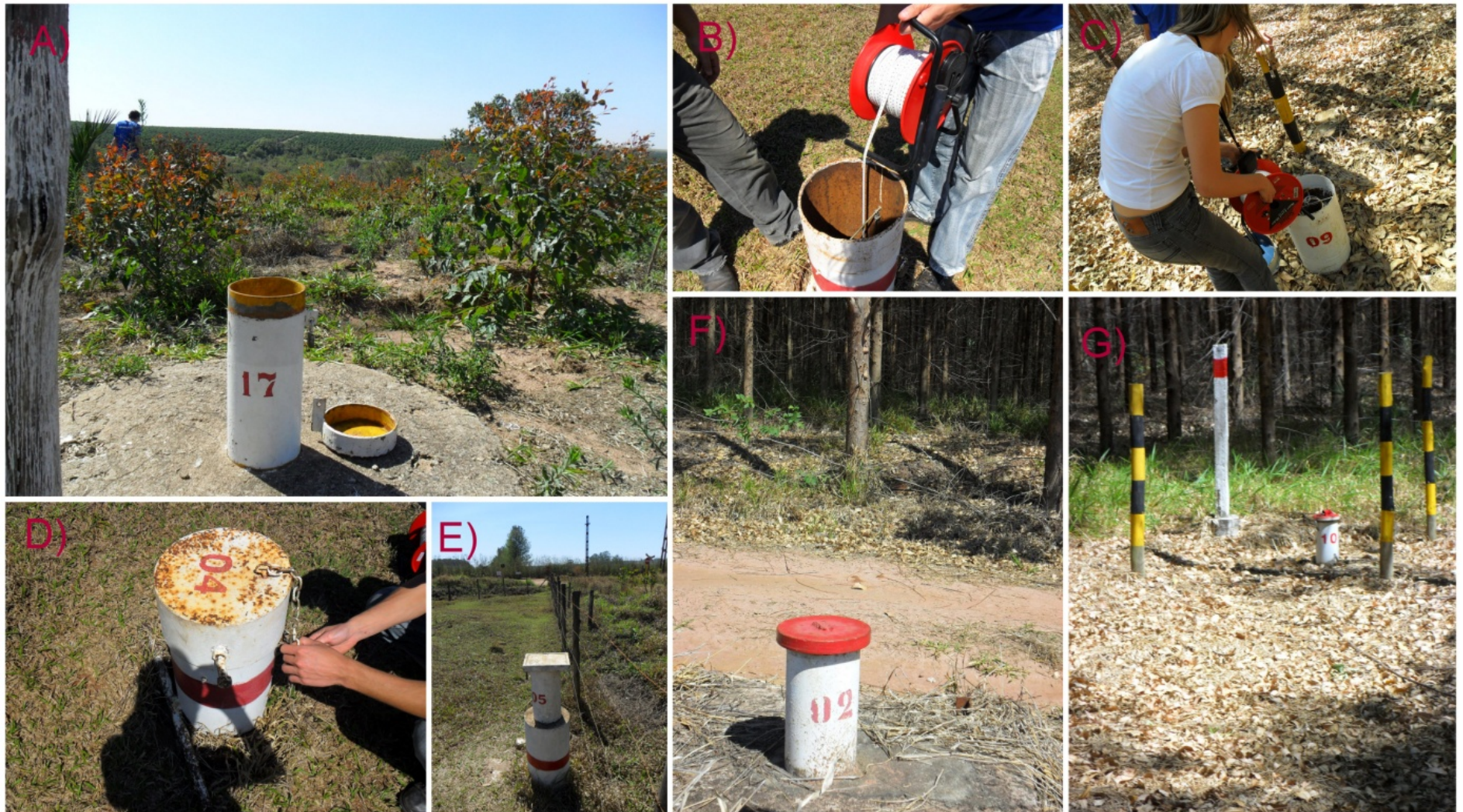
Figura 3- Imagens do trabalho de campo realizado na Bacia do Ribeirão da Onça em Brotas-SP, (A= Poço em eucalipto novo, B= Medição do nível freático em área de pastagem, C= Medição do nível freático em área de eucalipto adulto, D) Poço 4, E) Poço 5, F) Poço 2, detalhe para perímetro de proteção feito com concreto, G) Poço 10). Figura 3: Imagens do trabalho de campo realizado na Bacia do Ribeirão da Onça em Brotas-SP, (A= Poço em eucalipto novo, B= Medição do nível freático em área de pastagem, C= Medição do nível freático em área de eucalipto adulto, D) Poço 4, E) Poço 5, F) Poço 2.
