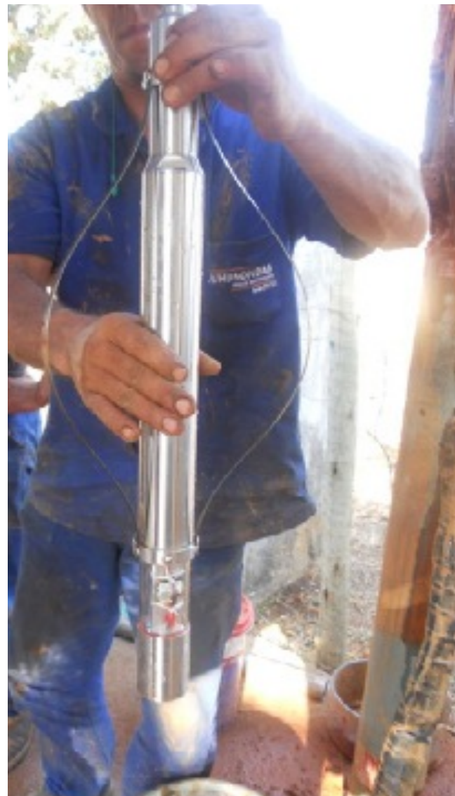
Sensor óptico responsável pela captação das imagens.
