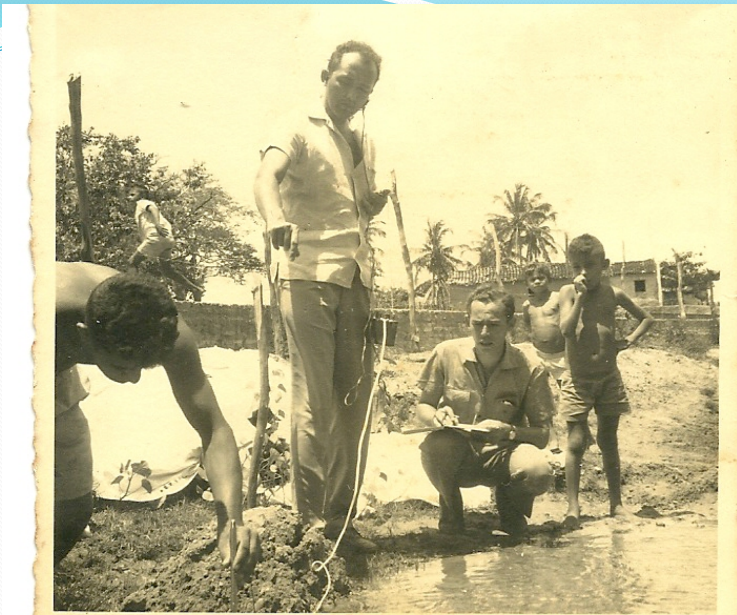
Foto 8 – Aldo Rebouças e João Manoel (agachado) em medição com micromolinete, da descarga da Fonte de Pureza – RN, no calcário Jandaíra -Bacia Potiguar – 1972.
