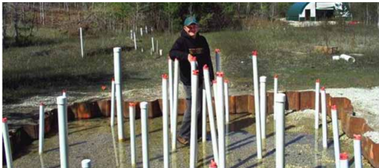
Experimento de campo em Borden, Canadá, mostrando a instrumentação utilizada para se determinar o rendimento da remediação de LNAPL utilizando injeção de água supersaturada em CO 2 , uma técnica avançada de “sparging”
