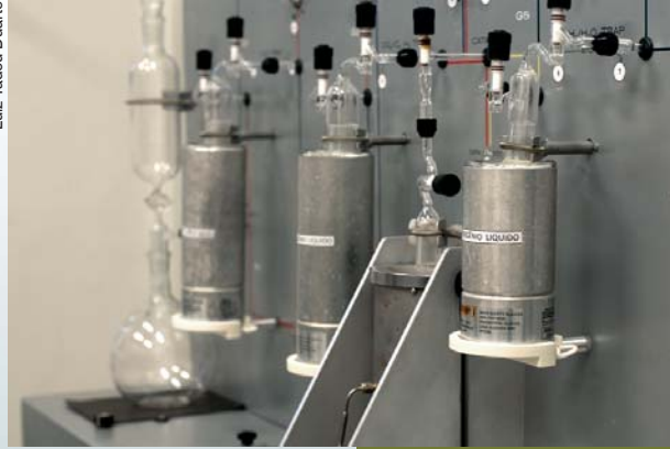
Acima, detalhes da linha de síntese benzênica, utilizada na datação com C-14. Ao lado, uma etapa do processo, com a formação do carbeto de lítio
