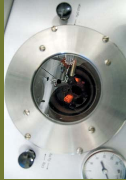
Acima, detalhes da linha de síntese benzênica, utilizada na datação com C-14. Ao lado, uma etapa do processo, com a formação do carbeto de lítio
