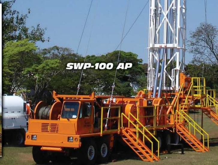
A Prominas na vanguarda do desenvolvimento, lançou a primeira Sonda de Produção Terrestre para operação em poços de petróleo para até 5.000 m, modelo SWP-100 AP, com capacidade de carga de 100 ton e altura livre sob o coroamento de 29 m.
