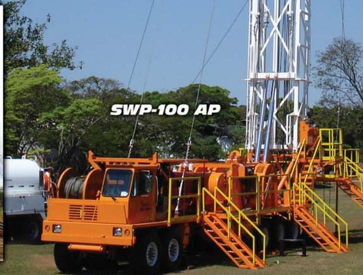
A Prominas na vanguarda do desenvolvimento, lançou a primeira Sonda de Produção Terrestre para operação em poços de petróleo para até 5.000 m, modelo SWP-100 AP, com capacidade de carga de 100 ton e altura livre sob o coroamento de 29 m. Atendendo aos requisitos da norma API e conteúdo local maior que 75% estabelecido pela ANP. Da R-0 até a SWP-100 AP, temos uma linha completa de equipamentos e ferramentas para atender as suas necessidades.
