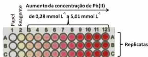
Imagem de um dispositivo microfluídico em papel contendo o complexo de rodizonato de chumbo nas concentrações de Pb 2+ (0,28 a 5,01) mmol L -1
