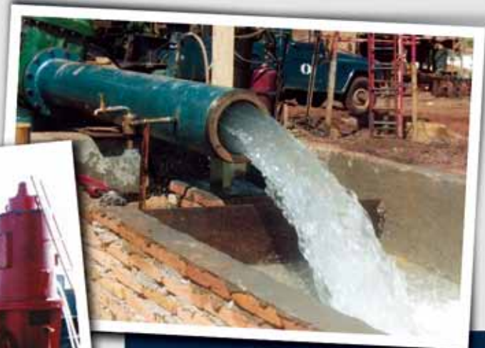
Teste de Bombeamento em Poço CPRM São José do Rio Preto (SP) - 1978
